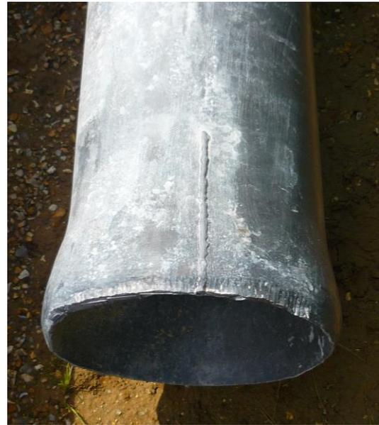
Les soudures pratiquées actuellement sont faites à partir d'un mélange de 33% d'étain et 77% de plomb. Ce mélange est acheté déjà prêt, sous la forme de lingots. Il s'agit du mélange qui tient le mieux sur le plomb très pur commercialisé actuellement.
