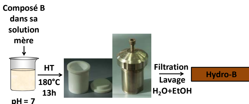
Figure 5. Schéma du protocole de synthèse du composé hydro-B (HT est l'abréviation de « procédé hydrothermal »).
