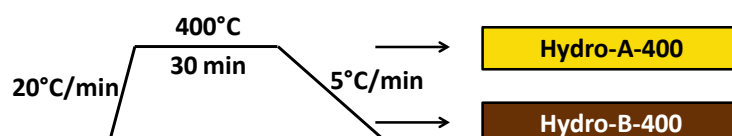
Figure 6. Schéma du traitement thermique appliqué aux poudres hydro-A et hydro-B filtrées et lavées.
