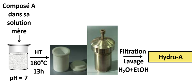
Figure 4. Schéma du protocole de synthèse du composé hydro-A (HT est l'abréviation de « procédé hydrothermal »).
