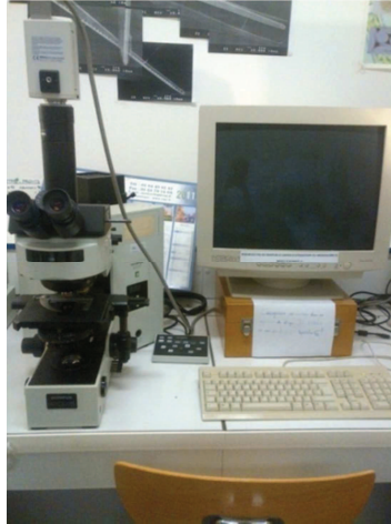
Figure 50: microscope optique et système d'acquisition utilisés pour la détermination de l'épaisseur des thalles
