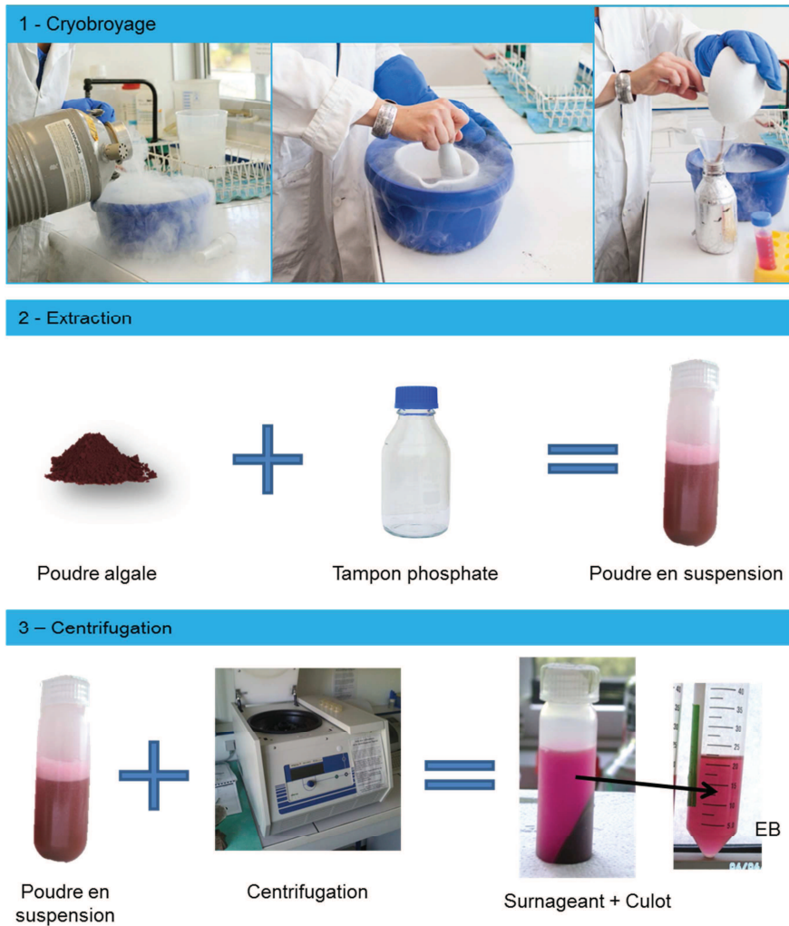
Figure 29: étapes du procédé d'extraction des composants hydrosolubles
