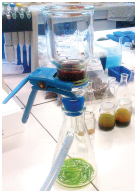
Figure 46: filtration du macérât d'algue sur Buchner
