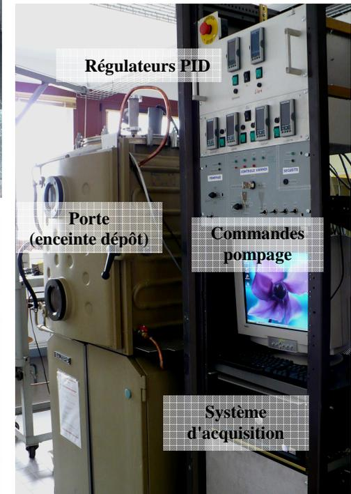
**Figure 1-1:** Schéma de l'enceinte de dépôt comprenant les boucles de régulation de température (à gauche) et les photographies associées (à droite).
