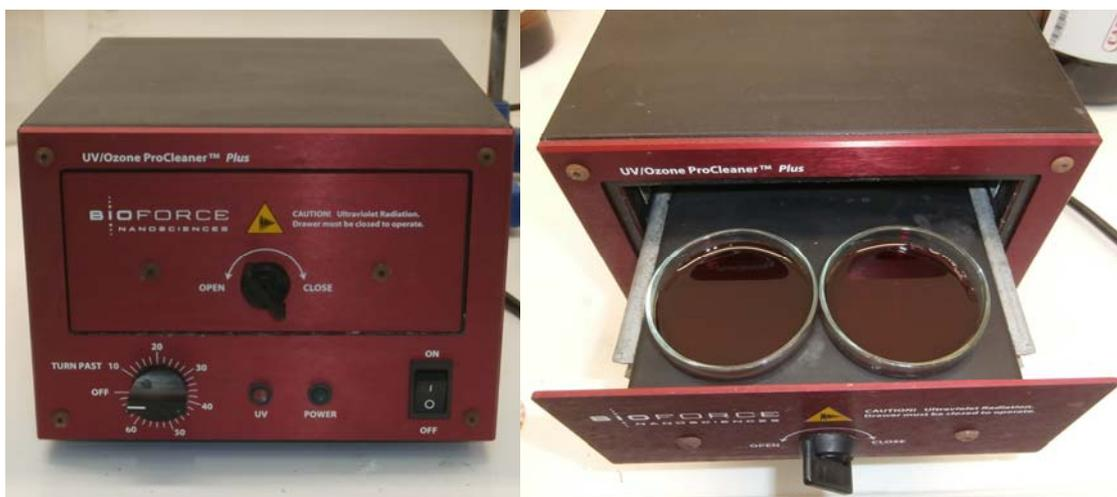
Figure III-1 : Photos du ProCleaner UV/Ozone utilisé pour la peroxydation des sols TiDMF
