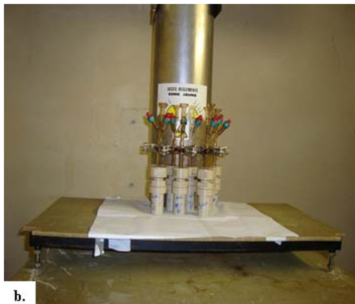
Figure II. 1 - a. Schéma de la source panoramique de ^{60}\text{Co} du Laboratoire de Chimie Physique ; b. Photographie de la géométrie d’irradiation de nos cellules autour de la source de ^{60}\text{Co} .
