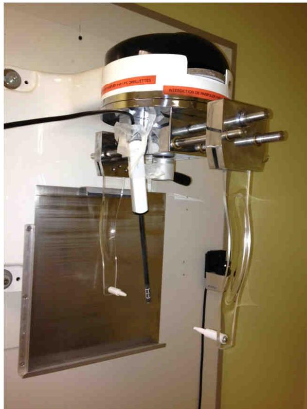
**Figure 20 : positionnement de la sonde dosimétrique dans le céphalostat utilisé pour les téléradiographies**
