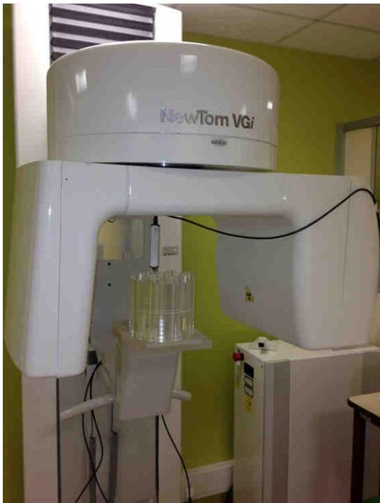
**Figure 16 : installation du fantôme et du dosimètre dans le CBCT permettant de mesurer le CTDI**
