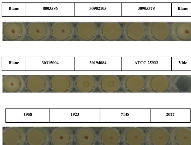
**Figure 17 :** Photographie d'une microplaque en méthode Ring Test<sup>®</sup>. Après incubation, un aimant est disposé sous le fond des puits. En l'absence de biofilm, toutes les microbilles sont attirées dans le fond du puits et forment un spot central (BFI > 7). Lors de la formation de biofilm, les microbilles sont immobilisées et il n'y a pas de spot central.
