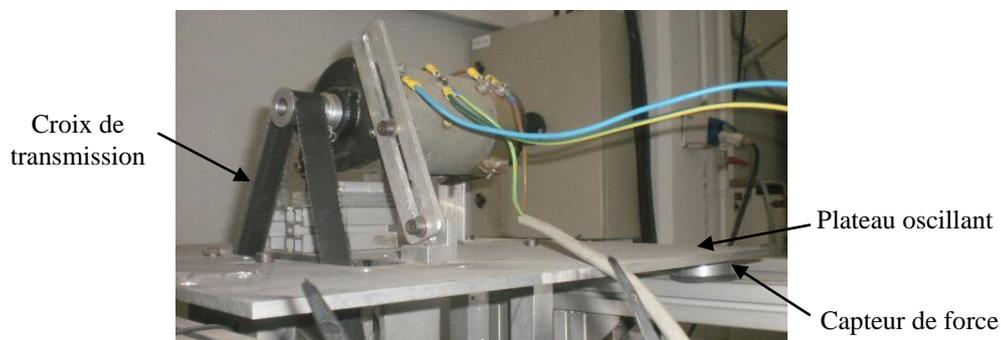
Figure 3.6. Photo de l'installation du capteur de force
