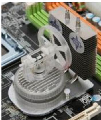
Figure 1.13. Microprocesseur refroidit par un moteur Stirling
