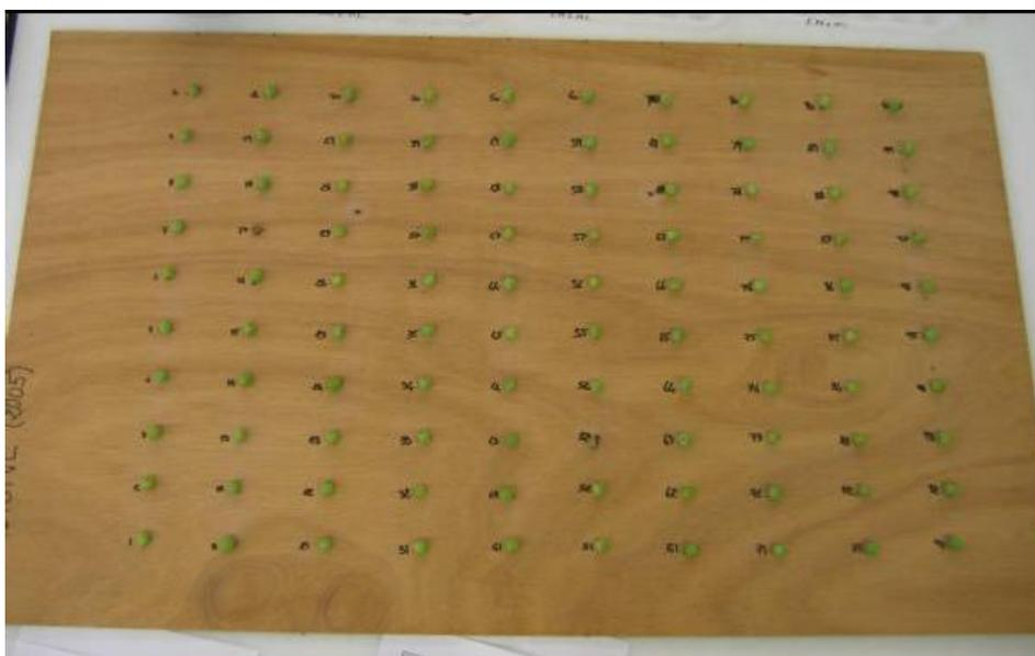
Figure 21. Système de planche à trous permettant de répartir aléatoirement 100 baies.
