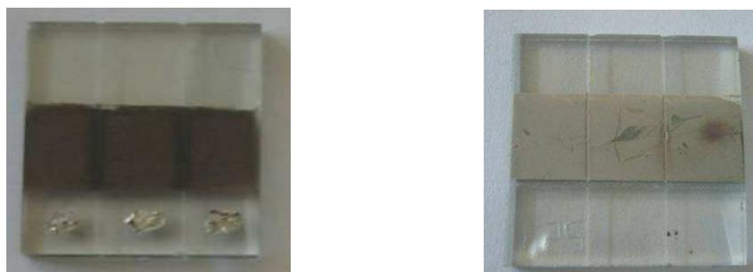
**Figure 53 : photographie de cellules de CuGaO<sub>2</sub> frittées sous air (gauche) et sous gaz neutre (droite)**
