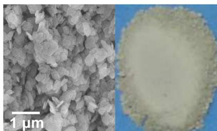
Figure 50 : photos MEB (gauche) et de la poudre (droite) de  $\text{CuGaO}_2$
