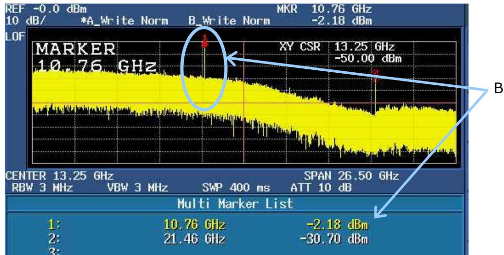
Figure I-6 : Mesure de la densité spectrale de puissance d'un signal PRBS RZ 10.709 Gbit/s
