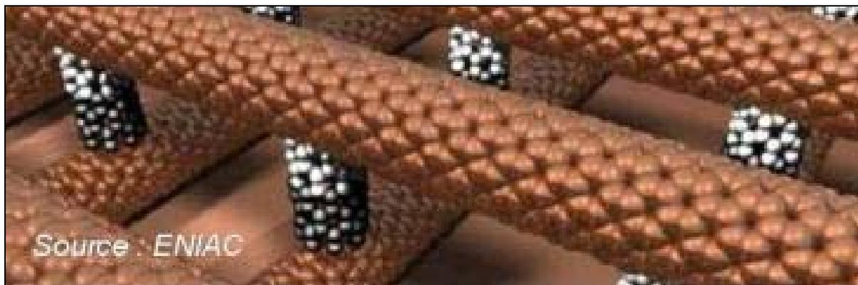
Figure 3 : Illustration d'une architecture 3D réalisée en NTC.
