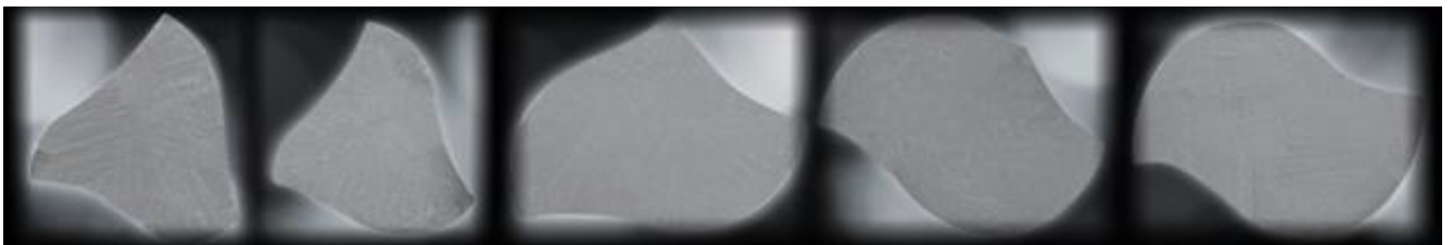
Figure 3 : Photographie des différentes sections du One Shape® observées en microscopie électronique à balayage, à 1,5mm, 3, 6, 9 et 12mm de la pointe (de gauche à droite)- (Doc. F. Pérez)
