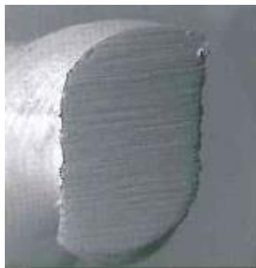
Figure 18 : Section asymétrique du Reciproc® avec deux angles de coupe observée en microscopie électronique à balayage - Pack marketing Dentsply® [13]
