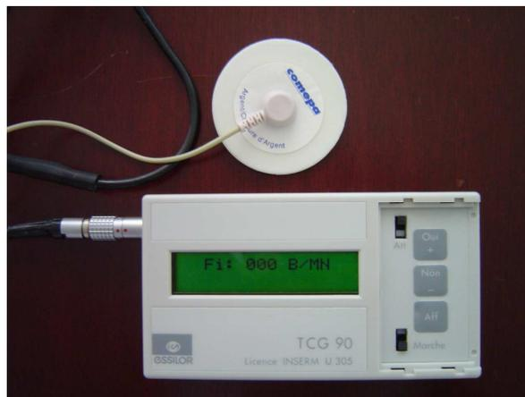
L'enregistreur adapte le pas de la mesure à la durée de l'enregistrement. Le pas de la mesure peut ainsi varier de 1 à 99 s. La capacité mémoire est de 5760 valeurs, ce qui correspond à une autonomie de 24h en mode 15s ou de 96min en mode 1 seconde.
