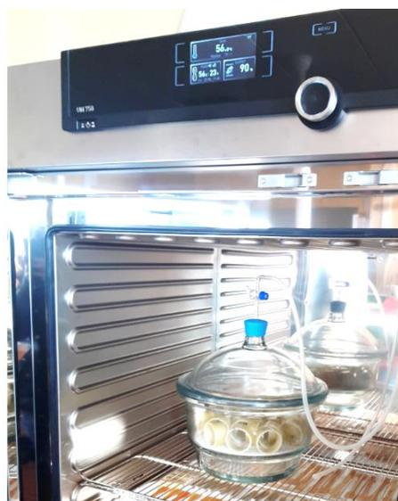
**Figure A3-10.** Désorption des anneaux composite dans l'étuve et sous dépression
