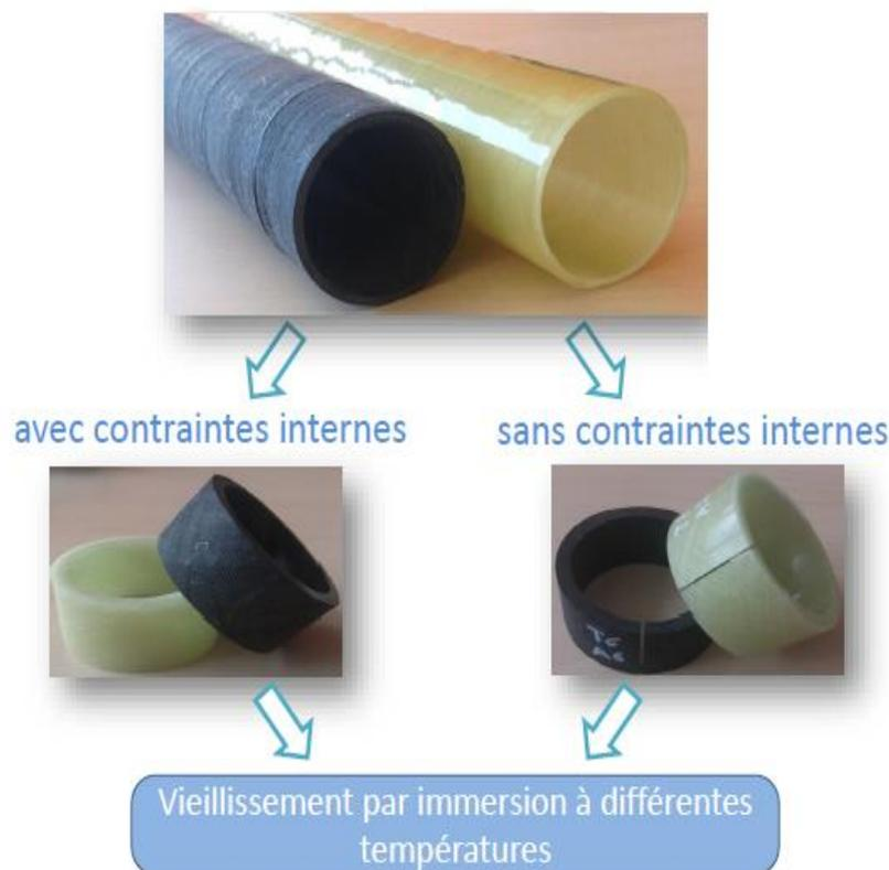
**Figure IV-1.** Méthodologie de la partie expérimentale
