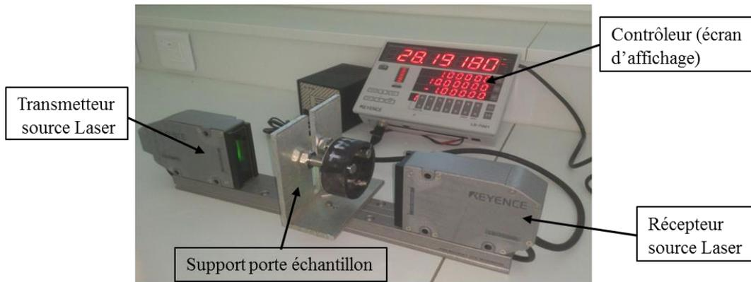
**Figure V-14.** Dispositif de mesure de l'évolution du diamètre des anneaux composites
