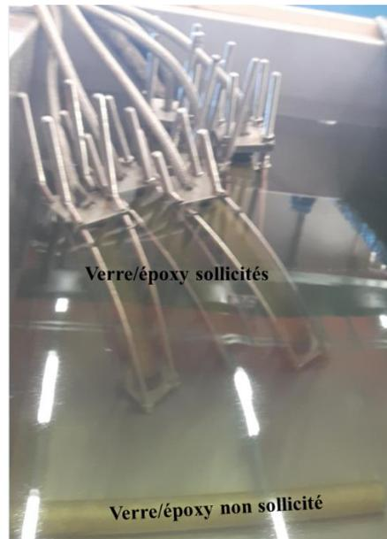
**Figure A3-9.** Tubes composites verre/époxy sollicités ou non, plongés dans le bac d'immersion
