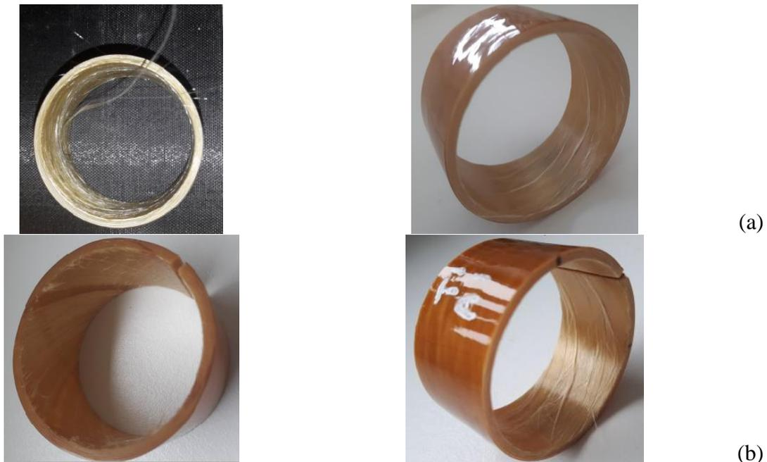
**Figure IV-11.** Dégradation de la surface intérieure des anneaux verre/époxy : (a) fermés et (b) ouverts
