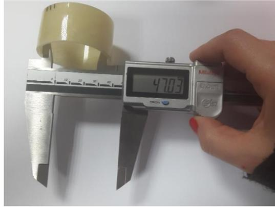
**Figure IV-6.** Mesures du diamètre intérieur au pied à coulisse
