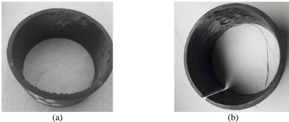
**Figure IV-16.** Dégradation de la surface intérieure des anneaux carbone/époxy : (a) fermés et (b) ouverts
