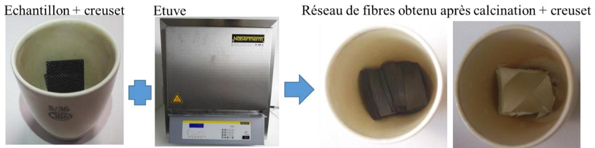
**Figure II-8.** Calcination des échantillons composites étudiés
