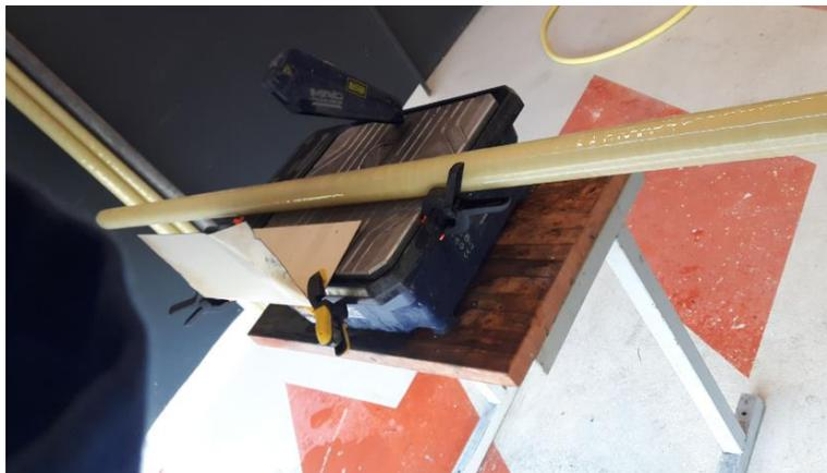
Figure A3-1. Découpe des tubes composites par la scie circulaire horizontale
