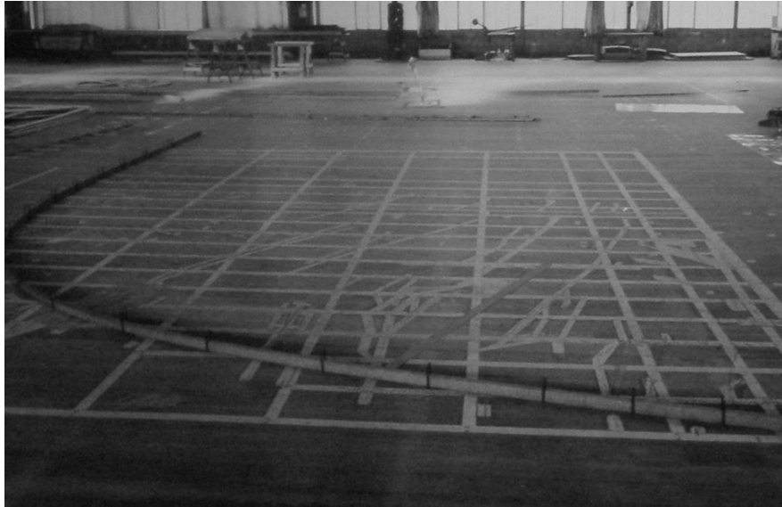
Photo 25 : Tracé sur plancher d'un vertical d'un escorteur d'union française
