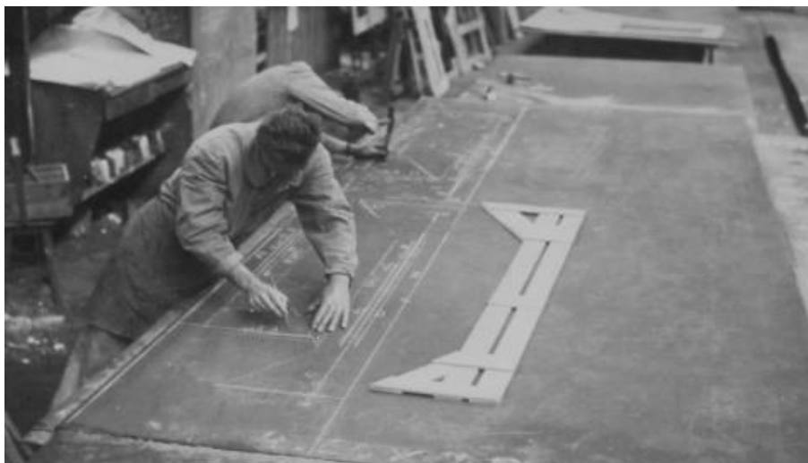
Photo 29 : Tracé à la pointe d'une tôle réservée aux escorteurs (gabarit en bois devant le traceur)
