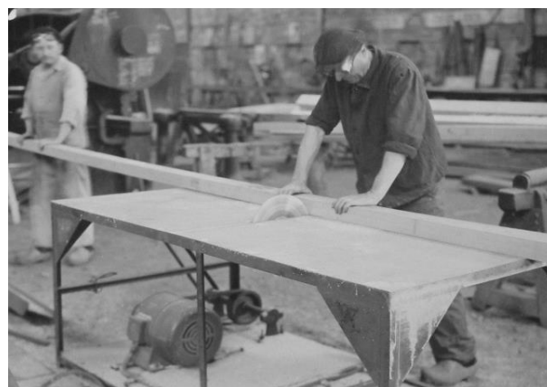
Photo 20 : Découpe à la scie à circulaire d'un profilé tôle en alliage
