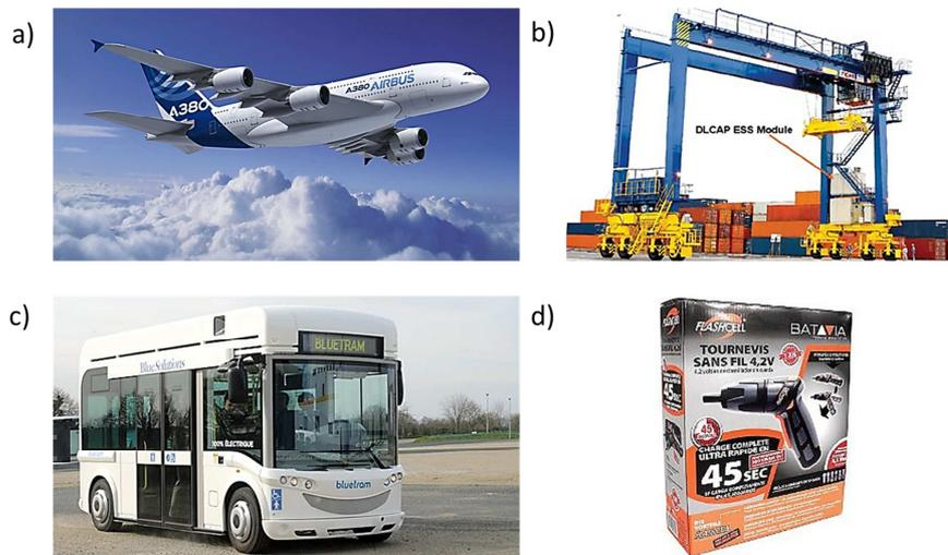
**Figure 1.13** Exemples d'applications de supercondensateurs a) ouverture des portes de secours de l'airbus A380, b) grue aéroportuaire stockage de l'énergie lors de la descente du plateau, c) Bluetram de Bolloré et d) tournevis électrique bénéficiant d'une charge complète en 45 sec.<sup>40</sup>
