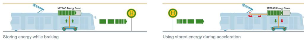
**Figure 1.12** Principe de fonctionnement des tramways équipés du système MITRAC<sup>39</sup>
