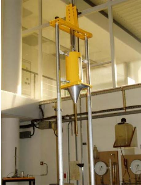
Pluviateur PSA4 doté de la buse de pluviation de la norme japonaise.
