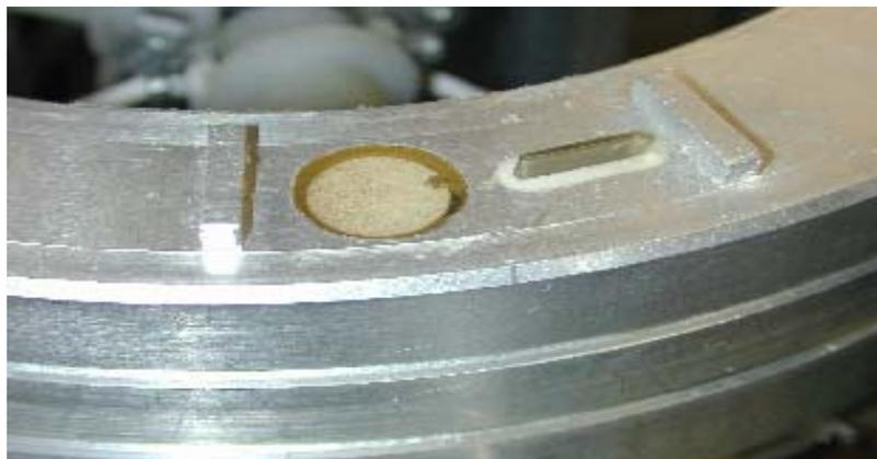
Figure 1.2. Association des bender elements et compression plates dans un cylindre creux [Di Benedetto et al., 2003].
