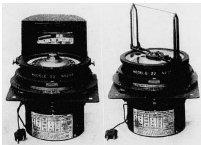
Figure 143 : Compas type Morel (utilisé par Costes à gauche et par Le Brix à droite). 1453
