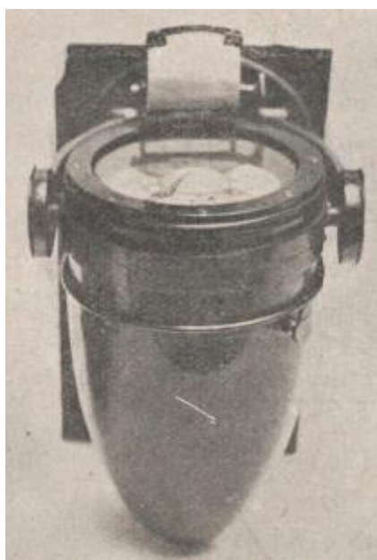
Figure 97: Compas de navigation aérienne (compas français A.M.1 de Dunoyer) 985
