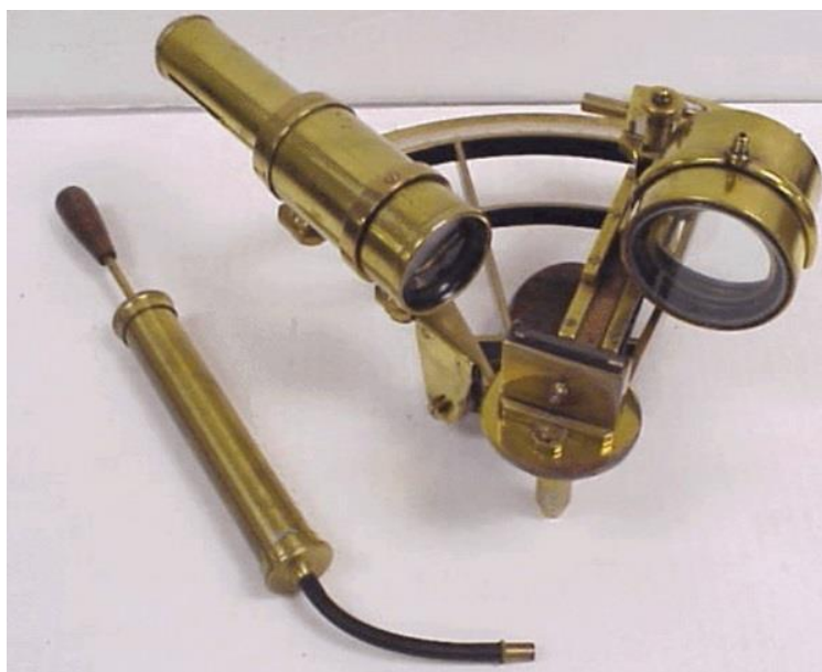
Figure 111 : Sextant gyroscopique Derrien-Bonneau. 1120
