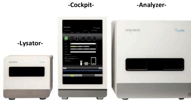
Figure 26 : Présentation du Lysator, du Cockpit et de l'Analyzer du système Unyvero Curetis®, de droite à gauche.
