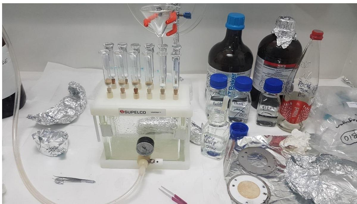
Figure 32 : Photo du système d'extraction en phase solide (SPE) utilisé pour l'extraction des POCIS. Il se compose d'une cuve d'extraction sur laquelle sont montées douze cartouches SPE et d'un entonnoir permettant le transfert de la phase. En bas à droite, un POCIS ouvert où l'on peut voir la phase (en marron-jaune) sur la membrane PES. Photo V. Dupraz.
