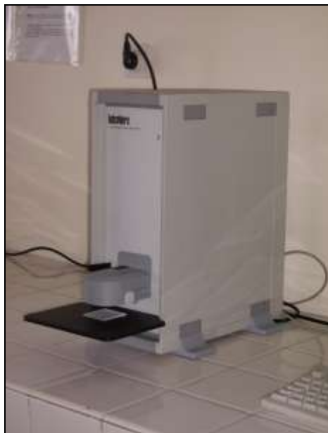
Figure 60 : Spectrophotomètre à sphère d'intégration utilisé
