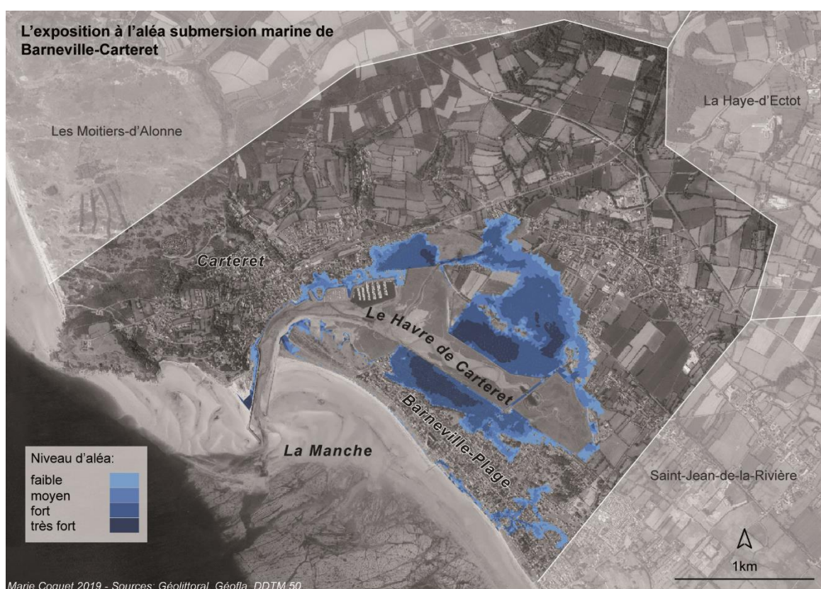
Figure 1.6 : L'exposition de la commune de Barneville-Carteret aux différents niveaux d'aléa submersion marine selon le scénario de référence de la cartographie aléa présente dans le PPRL. Sources : Géolittoral, Géofla, DDTM 50, réalisation : M. Coquet, 2019.
