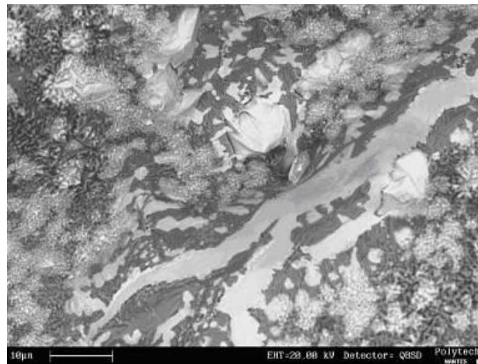
Figure 81 : Observation de phases ayant fondu lors de l'essai de traction à 1200°C.
