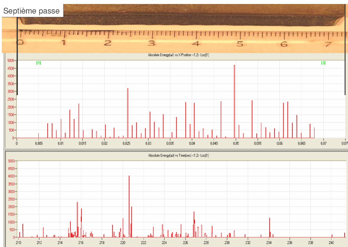
Détection temporelle des évènements acoustique intervenus au cours de la septième passe de rechargement.
