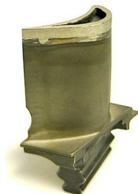
Figure 9 : Aube de turbine haute pression après réparation et usinage final.
