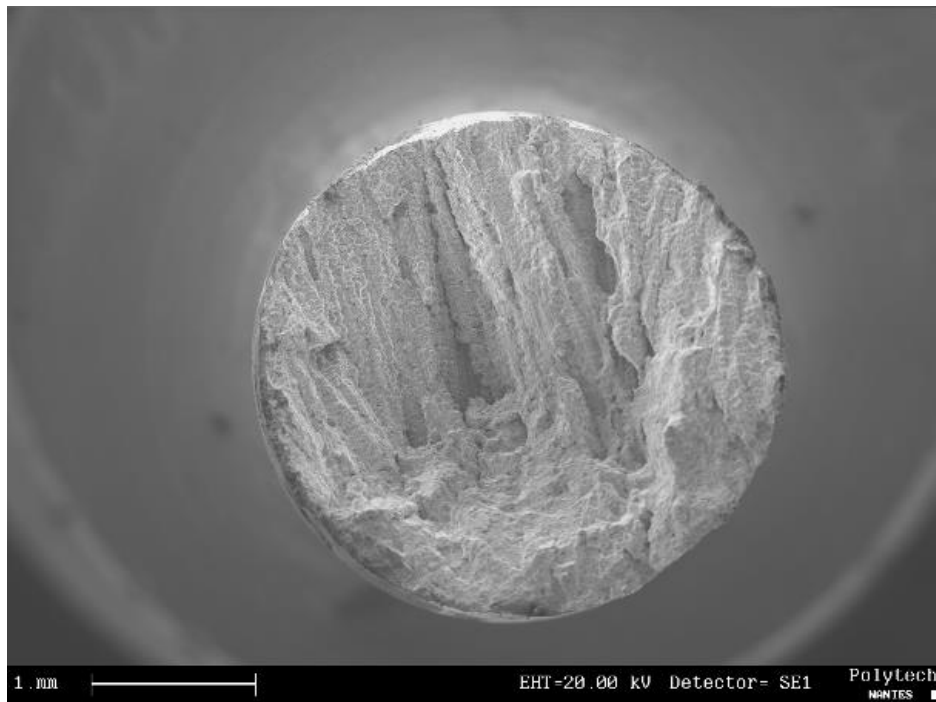
Figure 79 : Faciès de rupture de type interdendritique fragile sans présence de signes de ductilité sur la surface de rupture après essai de traction à 900°C.
