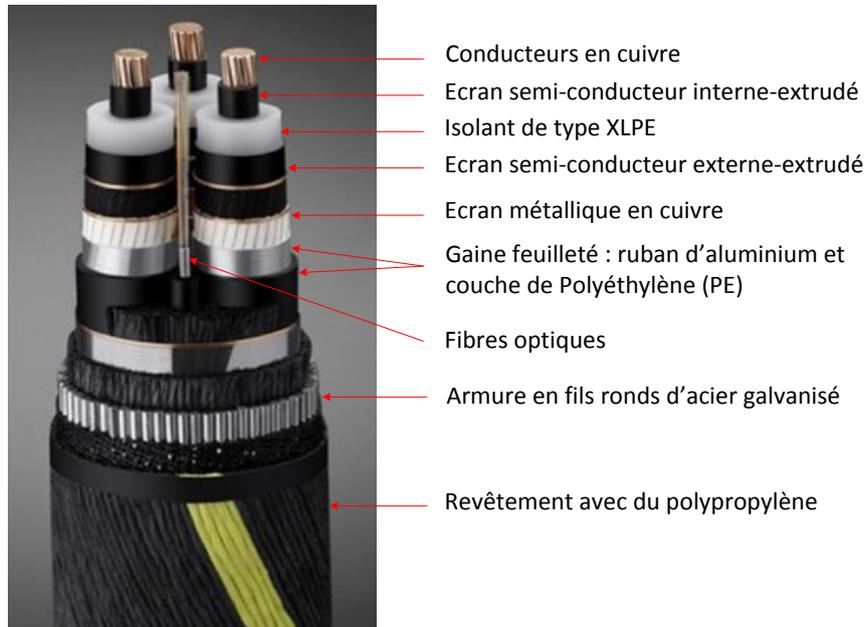
**Figure 1.14.** Composition d'un câble AC tripolaire à HT – Source : Nexans.
