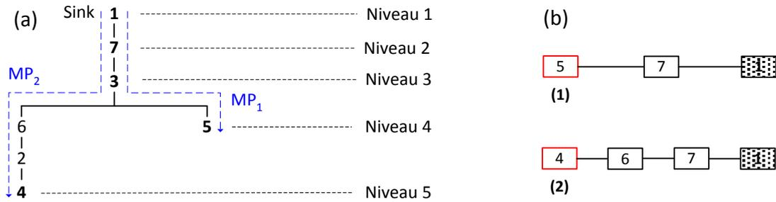
**Figure 4.21.** Etapes de la méthode de réduction des réseaux (a) arbre des chemins minimaux, (b) sous-systèmes du DF.
