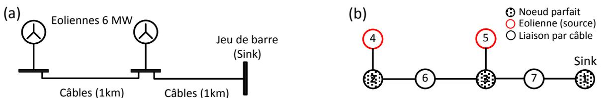
Figure 4.20. Exemple d'étude simple utilisé pour la validation des algorithmes développés : (a) schéma de raccordement électrique, (b) diagramme de fiabilité.
